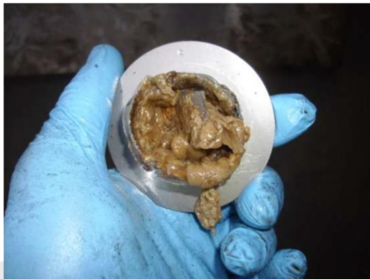
Foto: Voorbeeld micro-organismen in een filtersysteem.
