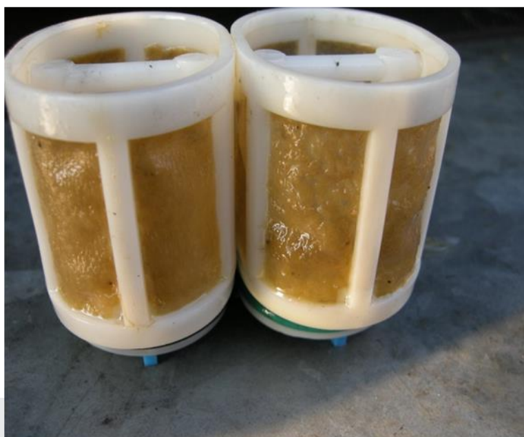
Foto: Voorbeeld verontreiniging filter met micro-organismen.
